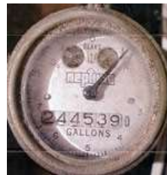
Compteur en gallons d'eau
